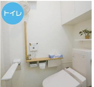
ベッドルームから奥様が一人でもトイレに行けるよう、トイレを移動しました。壁面にはカウンターの付いたL型手すりを、前面にも立ち上がりを補助する可動式の手すりを設置。車イスで入れる広さを確保し、座って使える洗面化粧台も併設しました。
